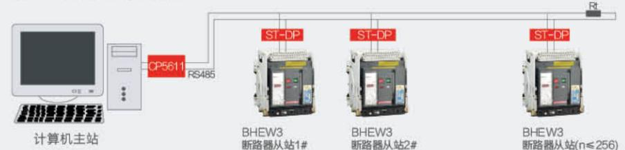
图中 ST-DP 为通讯协议模块，主站卡为 SIEMENS 公司的 CP5611，Rt 为网络终端电阻一般为 120Ω
